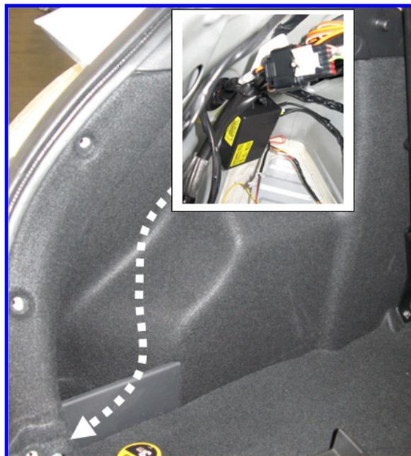
**SEGNALATORE ACUSTICO** : Fissare il segnalatore acustico (buzzer) sotto la copertura plastica del montante nel baule lato guida.
