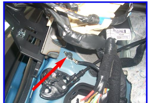
**NOTE :** Le connessioni dovranno essere eseguite con saldatura del cavo o crimpatura, e isolate tramite guaina termoretraibile o nastro isolante.
